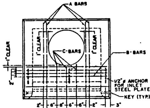
TOP SLAB REINFORCING PLAN
